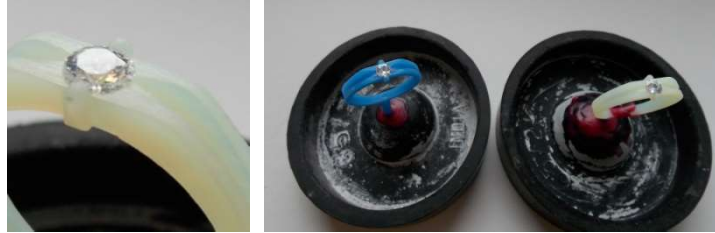
Pierres mises en place avant la coulée
